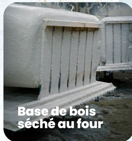
Nos bases sont réalisées en utilisant seulement du bois séché au four qui empêche la déformation - un problème commun. Avec une base solide, une résistance supplémentaire est fournie avec une couche supplémentaire de fibre de verre et de résine qui en fait la base la plus durable de l'industrie.
